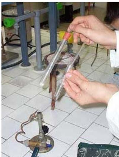
Lo sviluppo dell'anidride carbonica può essere favorito mediante un moderato riscaldamento della parte inferiore della provetta grande.
